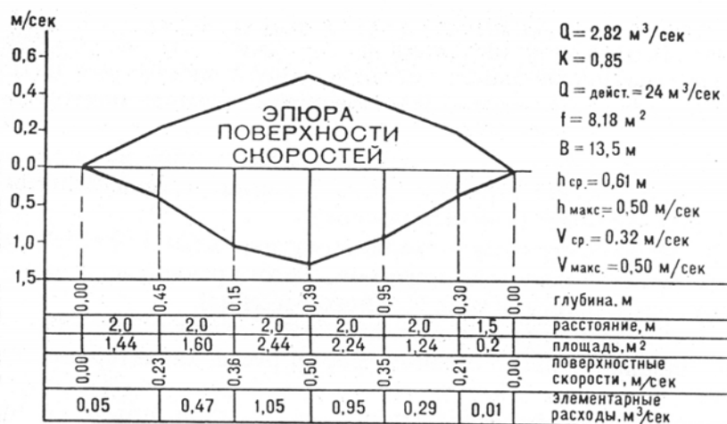
Рис. 13. Вычисление расхода воды графоаналитическим способом
