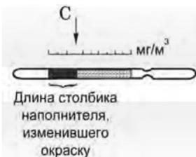
4. Отметьте изменение окраски наполнителя и длину прореагировавшего столбика наполнителя после прокачивания. Расположите индикаторную трубку рядом со шкалой, изображенной на этикетке, и определите величину концентрации углекислого газа (C<sub>2</sub>) в мг/м<sup>3</sup> по границе столбика, изменившего окраску.
