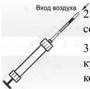
2. Подсоедините индикаторную трубку со стороны выхода воздуха к насосу.
